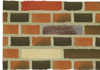
Bild 5. Datorgenererad bild där helsten och kopp har identiska mått, lika bild 4, fogen är ritad med det medelmått som gäller för det aktuella murverket.
